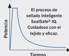
Gracias a la precisa corriente SealSafe® IQ, especialmente adaptada a la aplicación, solo el tejido localizado entre las ramas del instrumento es sellado, por lo que se pueden reducir a un mínimo absoluto los daños térmicos laterales en el tejido.
